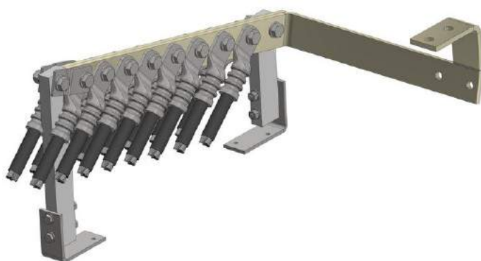
Středová propojka tlumivek č.v. 70764e LP/L 12x \varnothing 20/695 se sběrníci levá
